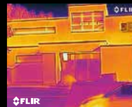
Rilevare problemi di isolamento
