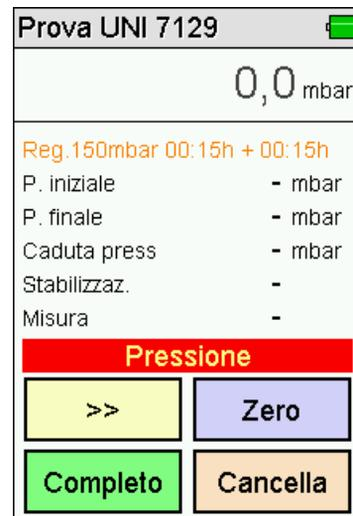
2. Stabilizzazione. Lo strumento inizia la fase di stabilizzazione con i parametri preimpostati e commuta automaticamente alla funzione misura
