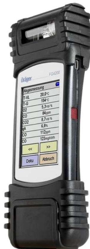
**Il kit include:** Sonda fumi da 180 mm., stampante, valigia, alimentatore, certificato di taratura emesso in data consegna, filtri anti-condensa, tubo per la tenuta impianto gas, istruzioni in italiano
