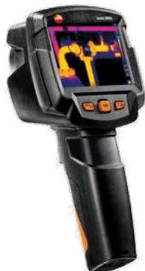
**Nell'edilizia** con una termocamera Testo potrete individuare ponti termici, zone a rischio di formazione delle muffe e difetti costruttivi.
