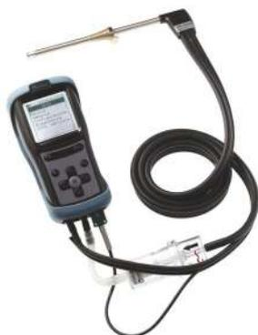
**I kit includono:** Sonda fumi da 180 mm., stampante (Bluetooth), valigia anti-polvere, alimentatore, certificato di taratura, tubo di misura pressione valvole gas
